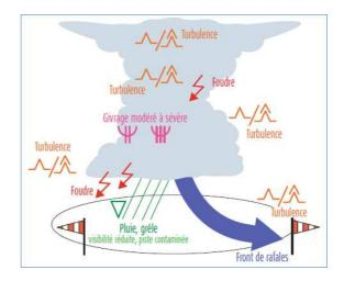
Turbulence: mouvements aléatoires de l'air se superposant au mouvement moyen.
